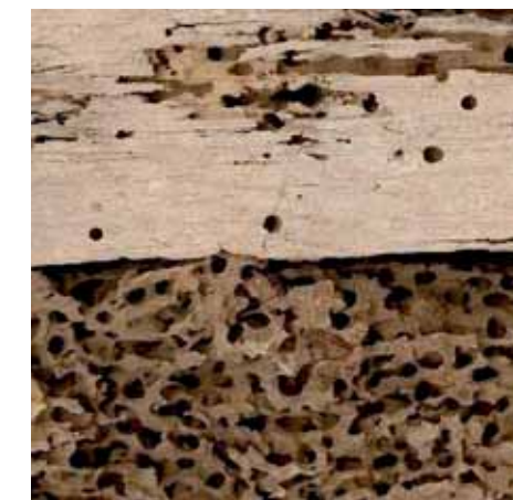
Schade van de bonte knaagkever. Kenmerkend zijn de ronde uitvliegopeningen met een diameter van 2 tot 3,5 mm (boven) en talrijke, ronde boorgangen binnenin het hout (onder) (foto Uwe Noldt)
